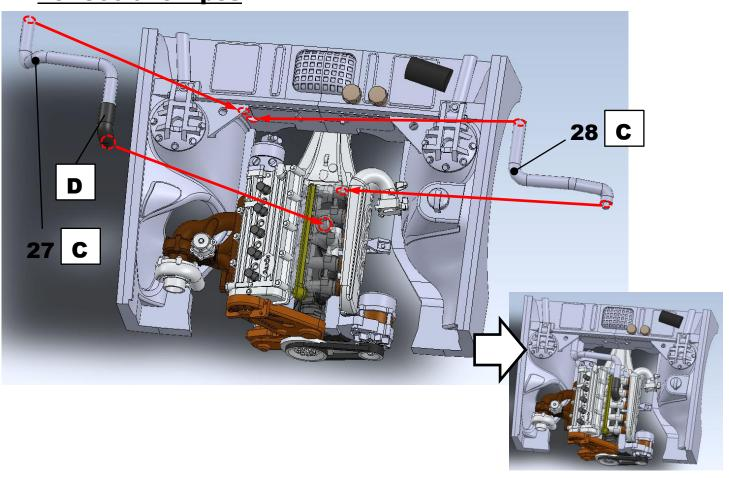
11. Air Pipes, spacer
